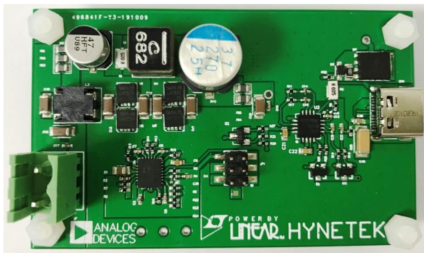
图 1. LT8390+HUSB350 USB PD 实物照片
