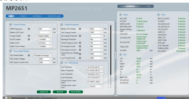
图 5. 设置 1 节电池充电电流 1A
